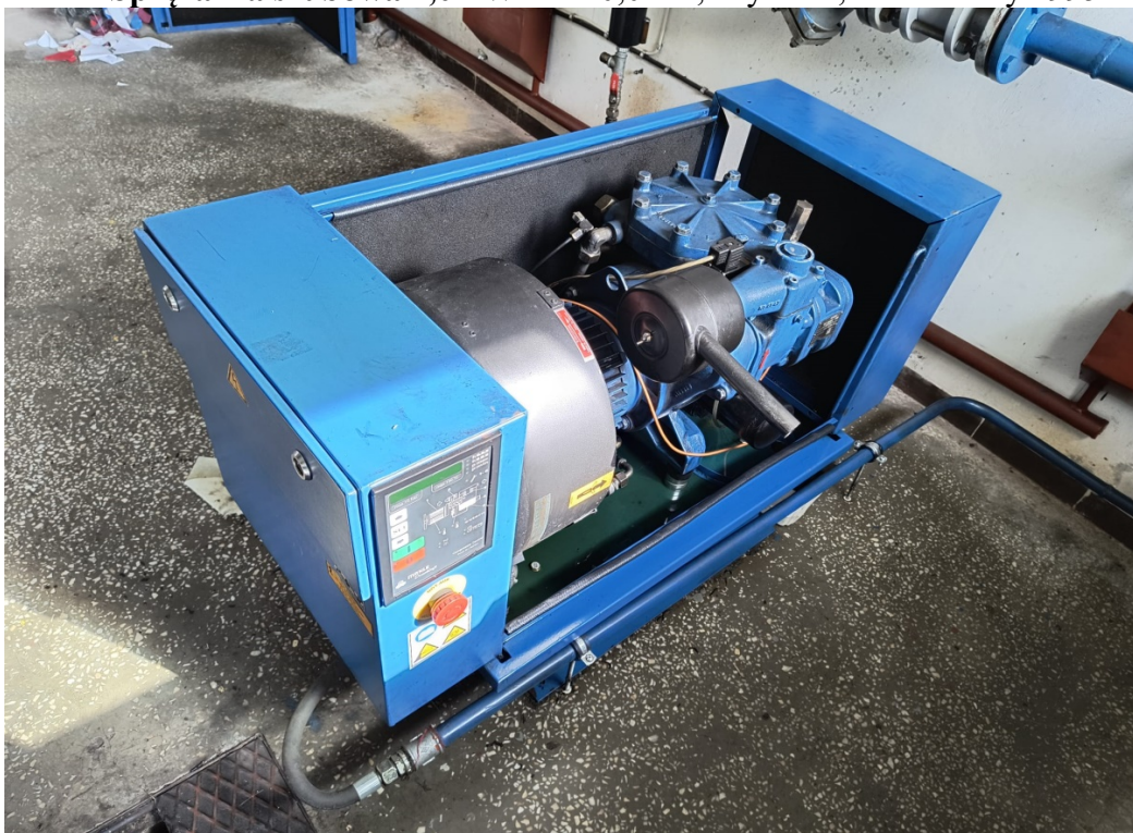
21. Sprężarka śrubowa 4,0 kW. P=10,0 bar, używana, rok budowy 1995.
